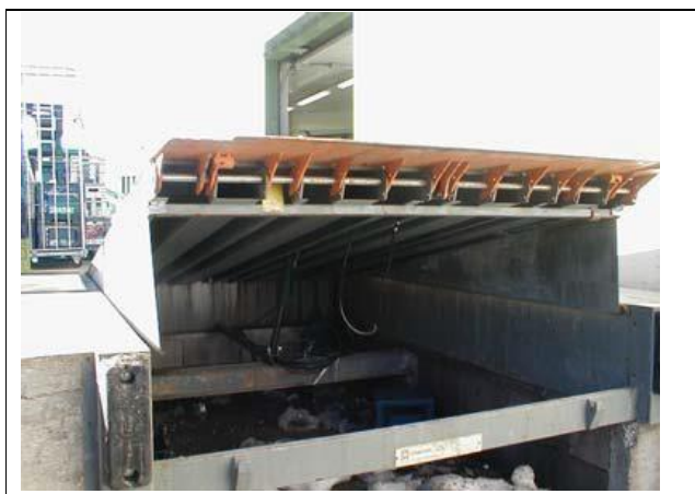
Pedana di carico motorizzata con pannelli rigidi laterali
