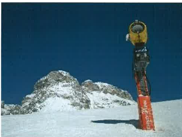
FOTO N. 20: CANNONE IN POSTAZIONE FISSA PER INNEVAMENTO ARTIFICIALE
